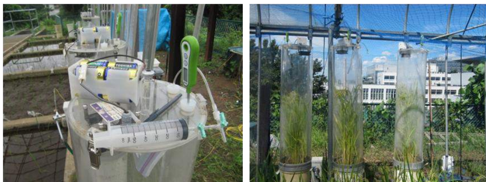
Gambar 2 Peralatan Pengukuran Konsentrasi GRK pada Percobaan di Pot
