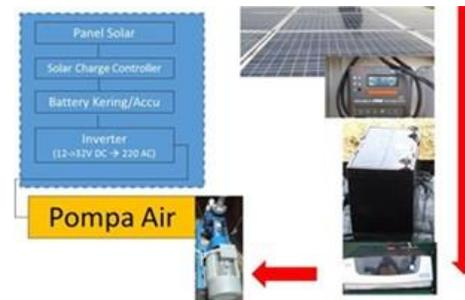
Gambar 3 Konfigurasi Pompa Air Tenaga Surya
